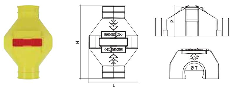
Coprigiunto poligonale di protezione e segnalazione del giunto sottostante. Doppio sistema di ancoraggio ad incastro alle due estremità con nervature di alloggiamento per eventuali fascette plastiche di legatura. Catarinfrangente con sistema antisganciamento. Articolo personalizzabile.
