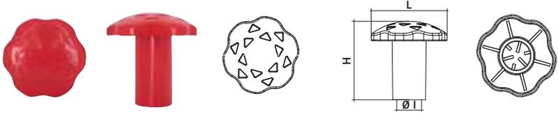
Fungo coprifermo di segnalazione ergonomico per tondini cm 6-22, con nervature interne alla calotta e speroni interni al tubo centrale per l'ancoraggio dei tondini in ferro.
