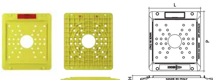
Sottobasetta quadrata per ponteggi con foro centrale di stoccaggio diametro 51 e fori a raggiera sulla superficie per lo scolo dell'acqua. Piatto di alloggiamento con foro di contenimento per la basetta metallica, inchiodabile ai 4 lati, impilabile e con griglia sottostante di ancoraggio. Catarinfrangente con sistema antiganciamento.
