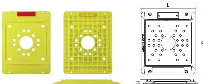
Sottobasetta rettangolare per ponteggi con foro centrale di stoccaggio diametro 51 e fori a raggiera sulla superficie per lo scolo dell'acqua. Piatto di alloggiamento con foro di contenimento per la basetta metallica, inchiodabile ai 4 lati, impilabile e con griglia sottostante di ancoraggio. Catarinfrangente con sistema antiganciamento. Certificata e personalizzabile.
