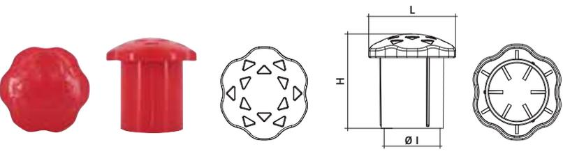
Fungo coprifermo di segnalazione ergonomico per tondini cm 22-35, con nervature interne alla calotta e speroni interni al tubo centrale per l'ancoraggio dei tondini in ferro. Doppia funzione che gli consente di essere utilizzato anche come tappo interno copritubo di protezione e segnalazione per staffe di ancoraggio o tubi sporgenti.
