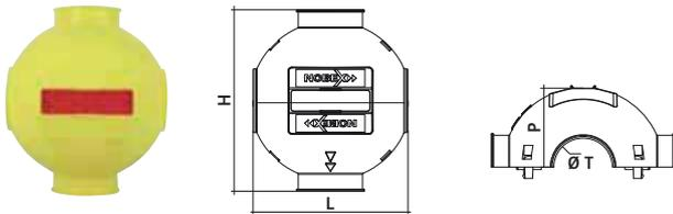
Sfera coprirosetta per ponteggi multidirezionali o come coprigiunto per montanti diametro 48 a croce. Nervature di alloggiamento per eventuale legatura aggiuntiva con fascette plastiche. Catarifrangente con sistema antisganciamento. Sistema con clip a incastro per la sfera, con indicazione del verso di installazione e personalizzabile con doppio logo.
