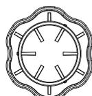
Fungo copriferro di segnalazione ergonomico per tondini cm 22-35. Con nervature interne alla calotta e speroni interni al tubo centrale per l'ancoraggio dei tondini. Doppia funzione che gli consente di essere utilizzato anche come tappo interno copritubo di protezione e segnalazione.
