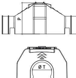
Coprigiunto poligonale di protezione e segnalazione del giunto sottostante. Doppio sistema di ancoraggio ad incastro alle due estremità, con nervature di alloggiamento per eventuali fascette plastiche di legatura. Catarifrangente con sistema antisganciamento. Articolo personalizzabile.
