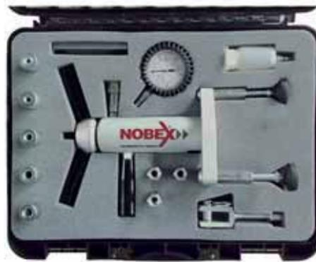
Kit tester portatile per prove di carico ancoranti 20 kN. Specifico per ponteggi.
