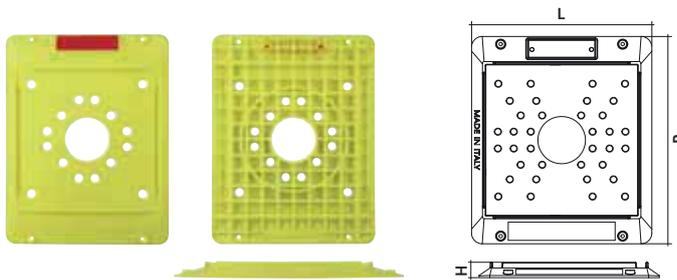
Sottobasetta rettangolare per ponteggi, con foro centrale di stoccaggio diametro 51 e fori a raggiera sulla superficie per lo scolo dell'acqua. Piatto di alloggiamento con foro di contenimento per la basetta metallica, inchiodabile ai 4 lati, impilabile e con griglia sottostante di ancoraggio. Catarifrangente con sistema antiganciamento. Certificata e personalizzabile.
