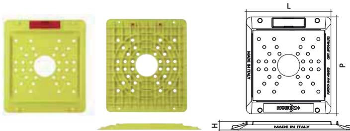
Sottobasetta quadrata per ponteggi, con foro centrale di stoccaggio diametro 51 e fori a raggiera sulla superficie per lo scolo dell'acqua. Piatto di alloggiamento con foro di contenimento per la basetta metallica, inchiodabile ai 4 lati, impilabile e con griglia sottostante di ancoraggio. Catarifrangente con sistema antiganciamento.
